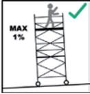
Fahrbare Arbeitsbühnen sind durch die Ausgleichsspindel oder durch Unterlegen von geeigneten Materialien lotrecht zu stellen. Die max. Neigung darf 1% betragen.
