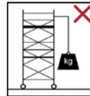
Das Anheben von schweren Gegenständen auf fahrbaren und das Anbringen und die Verwendung von Hebezeugen an fahrbaren Arbeitsbühnen ist nicht gestattet.
