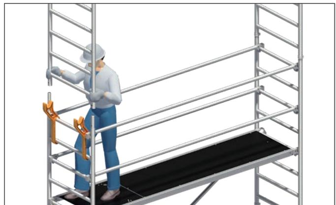
4. Durchstiegsbrücke 25 und Diagonalen 20 demontieren.
