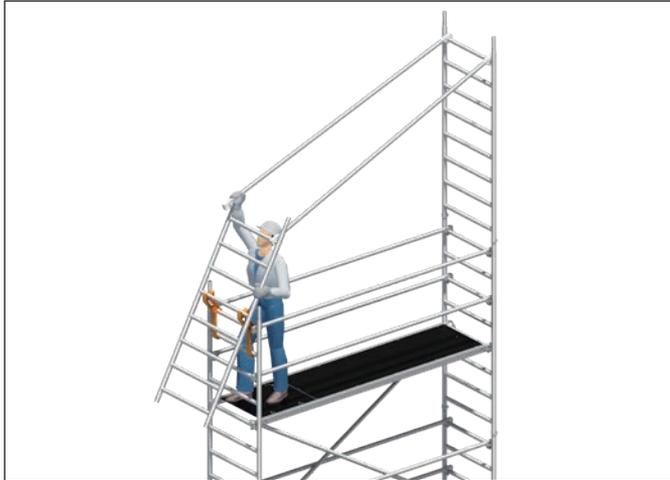
7. Einseitiges Aushängen der Geländer 17 aus der positionierten Standleiter.
