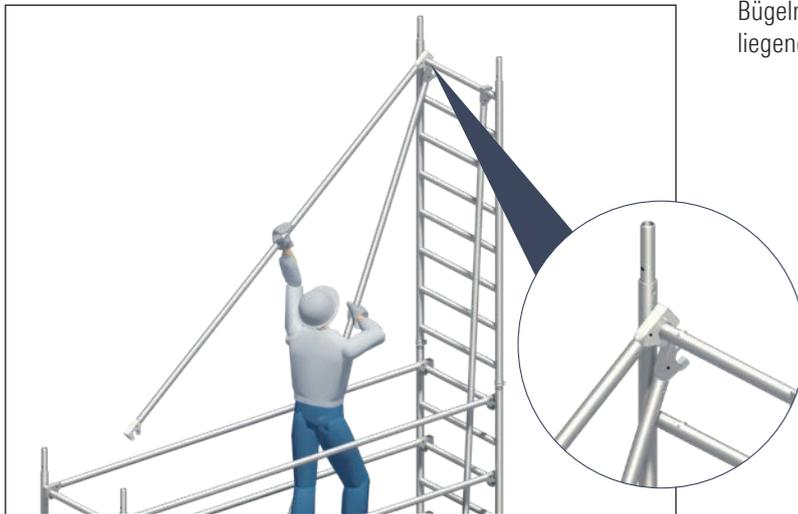
8. Demontage der Geländer 17 durch öffnen der Einrastklaue mithilfe von einem der unter 3. demontierten Zwischengeländer. Das lose Geländer 17 wird auf die 2. Sprosse von oben aufgelegt und wirkt als Hebel zum Öffnen des Schließbügels der Einrastklaue (siehe Detail).
