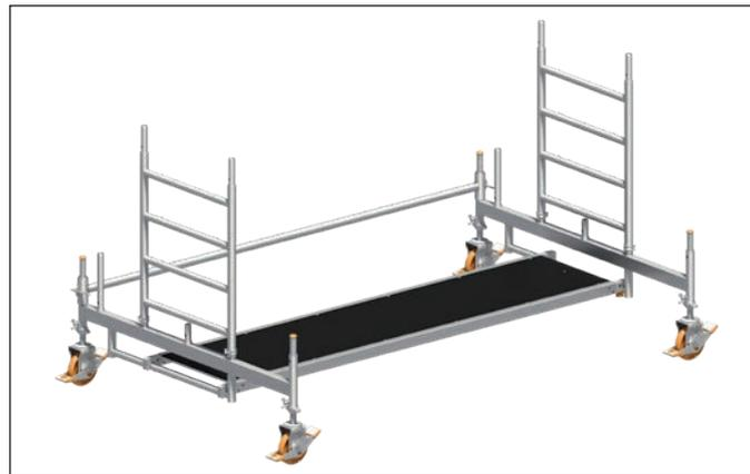
1. Die Lenkrollen 1 in die Fahrbalken 7/8 einstecken und durch Festdrehen der Flügelschrauben an den Spindelmuttern gegen Herausfallen sichern.
